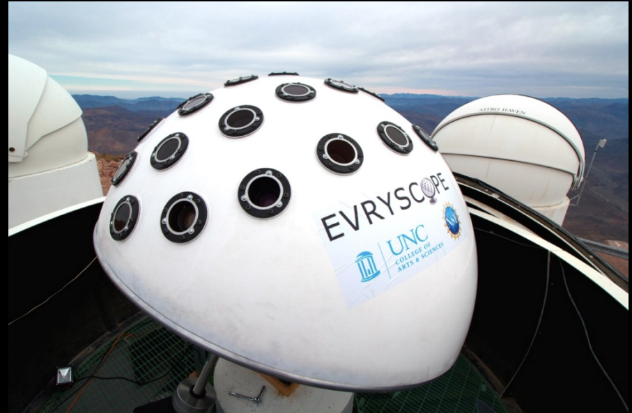
Evryscope: 24 x 61 mm-aperture telescopes
