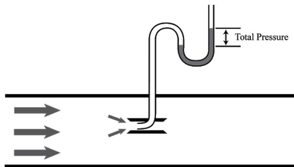
Figure 15: Kiel Probe Cross-section
